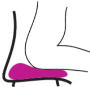
Para vaciar aire del cojín, inserte únicamente la aguja en la válvula, sin la bomba, ejerciendo una ligera presión sobre el cojín hasta que tenga el volumen deseado.
